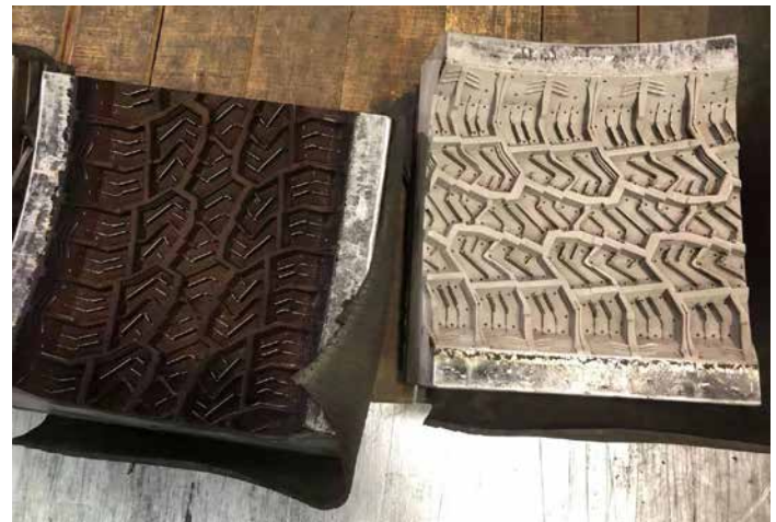
Przykład działania lasera czyszczącego: z lewej element przed czyszczeniem, z prawej po czyszczeniu
